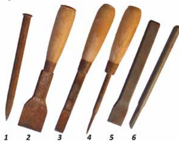
ill.5. Des outils de tailleurs de pierre : 1 Broche - 2 Ciseau de face - 3 Ciseau de face - 4 Ciseau de profil - 5 Chasse de face - 6 Chasse de profil. (Photo : R. Pellé)
