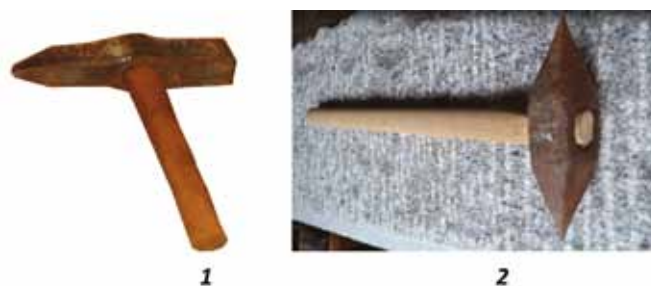
ill. 8. Têtu (1) et smille (2). La smille est une sorte de gros marteau dont les deux extrémités se terminent par une pointe et s'utilise pour des pierres très fermes.
